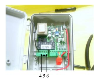
STEP 4: PROGRAM TRANSMITTER BY PRESSING THE SMART BUTTON THE RED LIGHT SHOULD LIGHT UP. THEN PRESS THE TRANSMITTER BUTTON 3 TIMES. (PLEASE STAND CLEAR OF THE DOOR)
